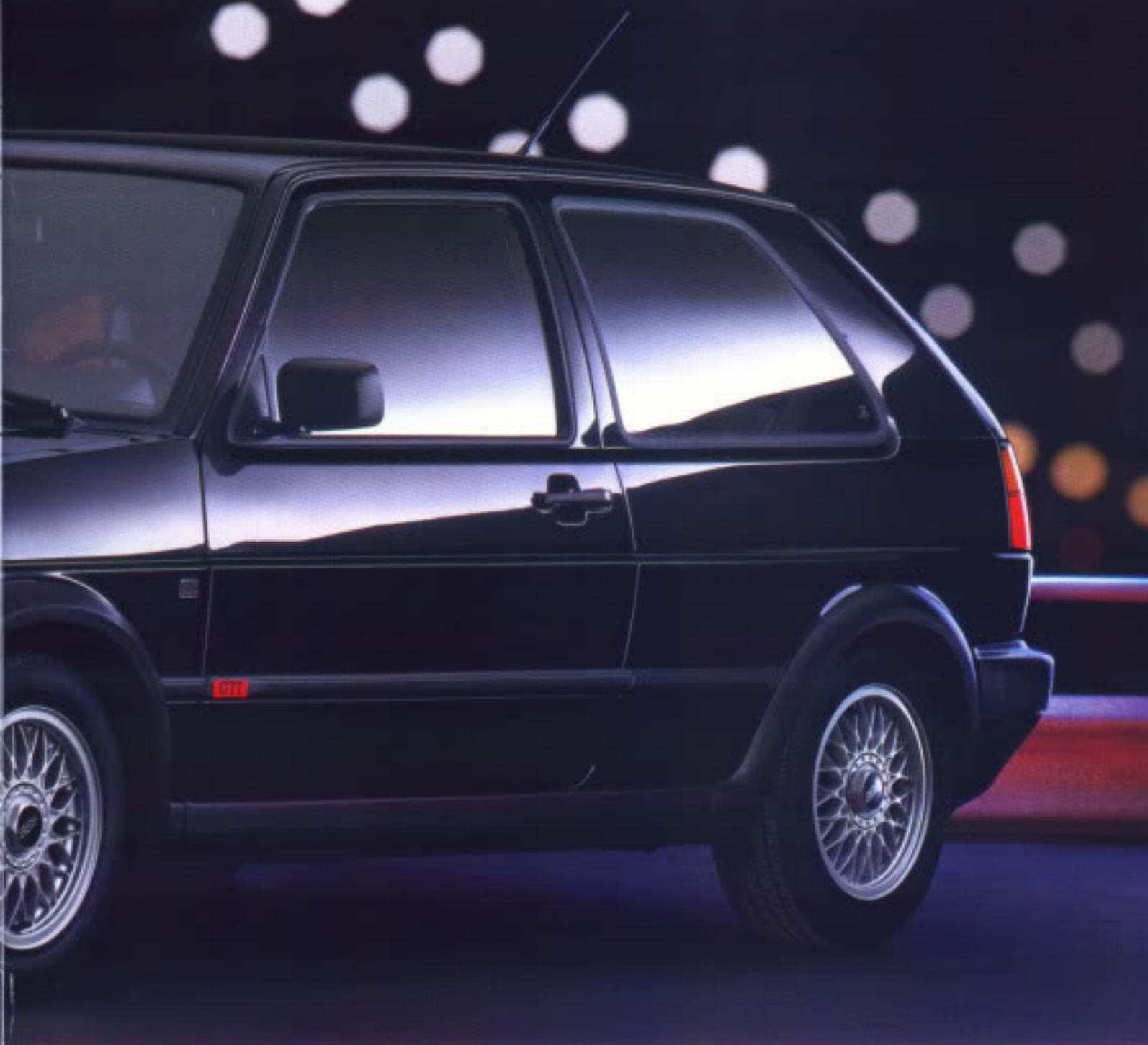
Kotflügel- und Schwellererweiterungen oder den 6½ J × 15 BBS-Leichtmetallrädern mit Breitreifen (195/50 R 15 V) aus.
