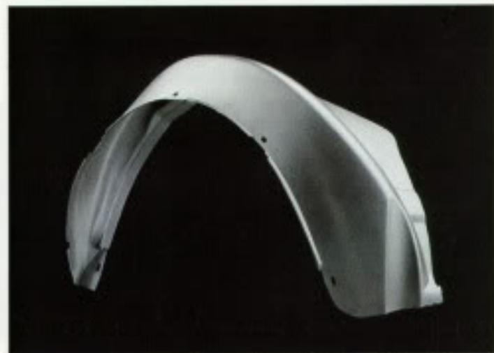
**Kunststoff-Anbauteile und Unterbodenschutz.** Steinschlaggefährdete Teile wie die vorderen Radhäuser sind mit Kunststoff-Schalen ausgekleidet. Nähte, Fugen und Falze werden mit einem Spezial-Füller versiegelt. Zuletzt wird der gesamte Unterboden mit einer dicken, dauerelastischen PVC-Beschichtung versehen. Diese und weitere Maßnahmen tragen dazu bei, daß Sie 3 Jahre Lackgarantie und 6 Jahre Gewährleistung gegen Durchrostung bekommen.
