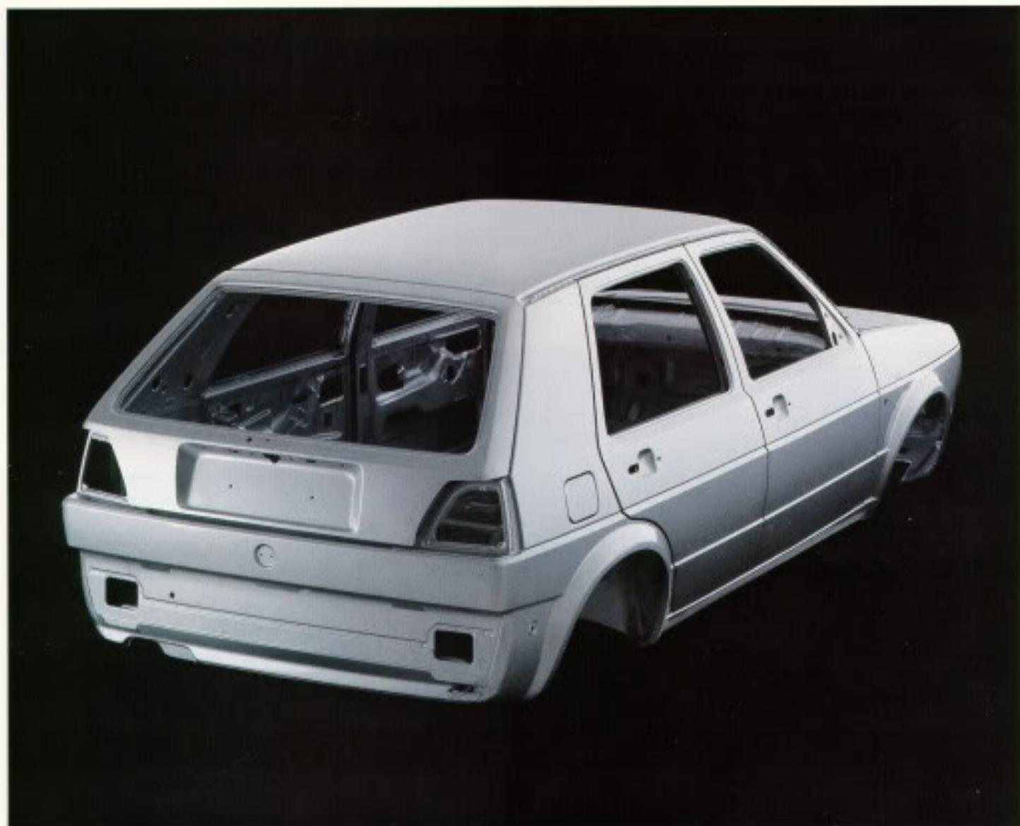
**Die korrosionsgeschützte Karosserie.** Die besonders korrosionsgefährdeten Karosserieteile werden aus ein- oder beidseitig verzinktem Blech hergestellt. Alle Hohlräume werden in einem automatischen Verfahren mit Heißwachs geflutet. So gelangt Wachs auch in die entferntesten Winkel der Karosserie.
