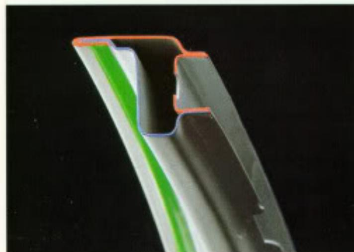
**Die Karosserieabdichtung.** An den stark belasteten Innenkanten von Motorhaube, Türen und Heckklappe werden die Bleche miteinander verklebt. Dadurch wird Kontaktkorrosion zwischen den Blechen verhindert. Damit keine Feuchtigkeit eindringen kann, erhalten Kanten und Falze eine PVC-Feinabdichtung.
