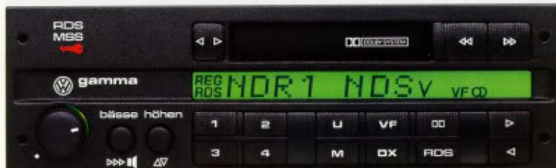
Das Radio-Cassettengerät „gamma“. Mit UKW-Stereo-/MW-Empfangsteil, Sendersuchlauf, 4 Stationstasten für je 4 MW-/UKW-VF-Sender, Radio-Data-System (RDS) incl. Verkehrsfunkteinrichtung, getrennter Höhen- und Tiefenregelung, Tipptastenbedienung, Display in Punktmatrix-Darstellung, Antidiebstahl-Codierung, Stereo-Cassettenteil mit schnellem Vor- und Rücklauf, elektronischem Autoreverse-Cassettenein-
