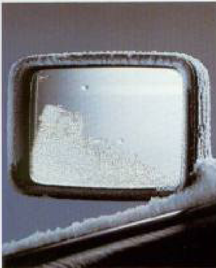
Das Spiegelglas ist elektrisch verstellbar und überheizbar. Antifrostpaket
