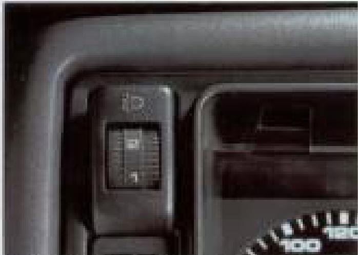
Die Leuchtweitenregulierung. Durch die vertikale Positionierung der Nadelwerte ist eine Einstellung möglich, die den Gegenverkehr nicht blendet.
