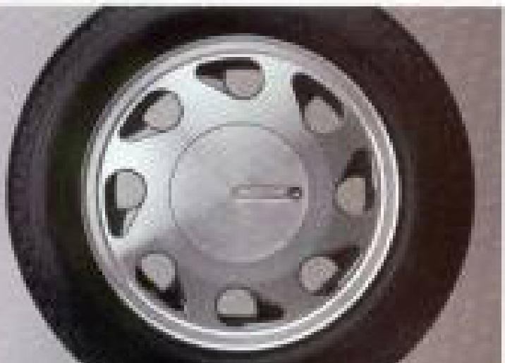
Das Leichtmetallrad 8 J x 16 mit 16 Lochhubzapfung und Elementen der Caddy-Design-Hub-Zentriertechnik. Design: Volkswagen.
